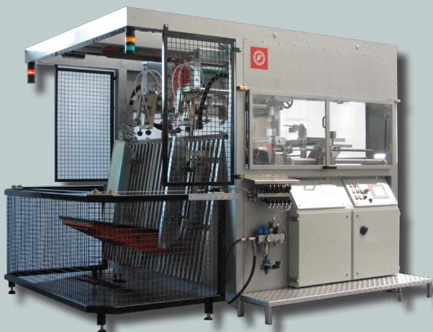
Alte prestazioni e grande versatilità, fino ad un massimo di **16 vassoi/min** formato 600x800. Chiusura con colla a caldo a lembo interno o esterno ed angoli smussati o arrotondati. Versione con carico manuale o automatico direttamente da paletta
